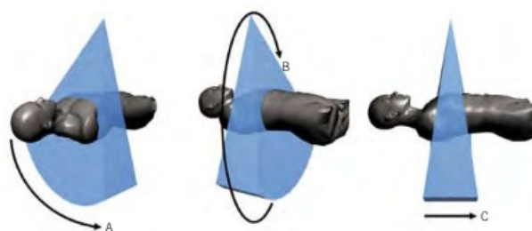
Ilustración 18 Medida de los perfiles de transmisión de rayos X. Fuente (Calzado & Geleijns, 2010)
